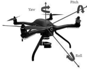
<그림 1> 드론의 Roll, Pitch, Yaw 설명
